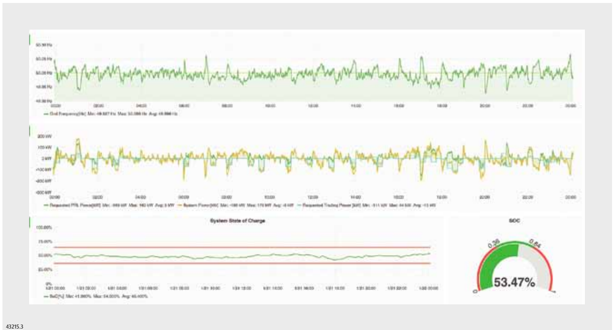
Bild 3. Leitsystem für das Monitoring der Energiespeicher
